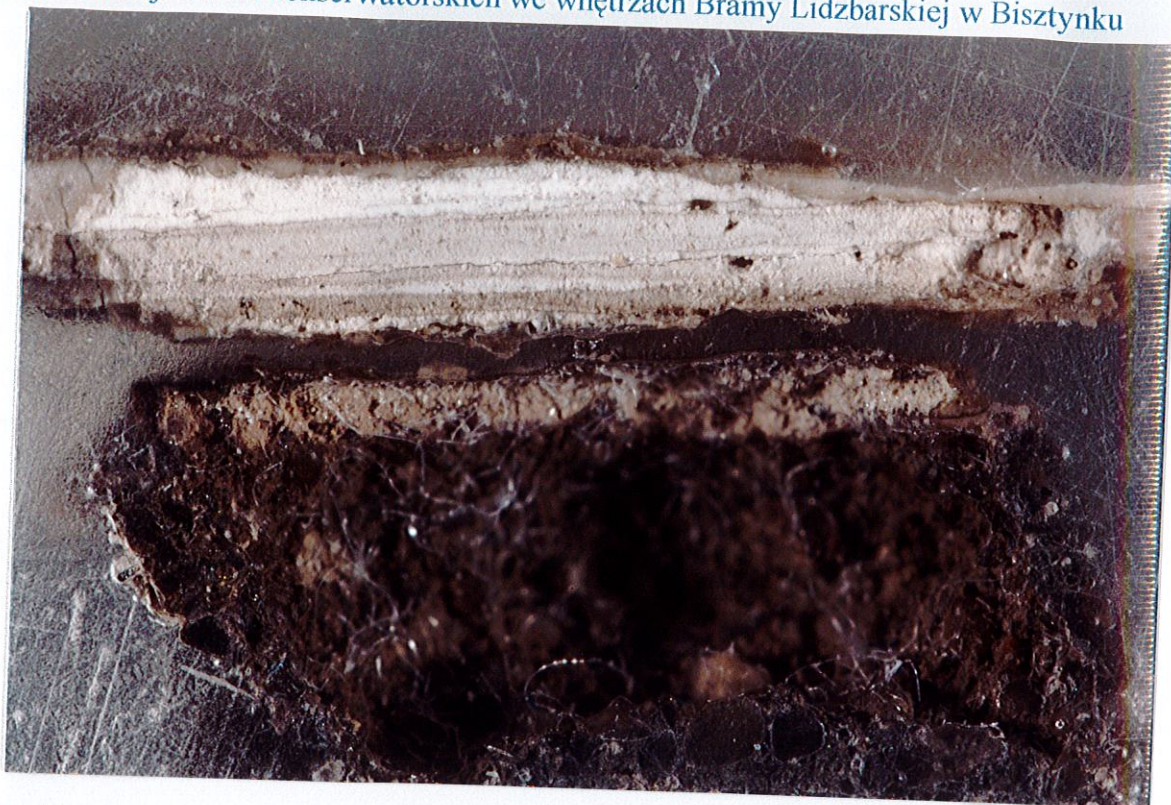
Fot. 12. Próbka nr 3 – dawna wnęka okienna na wschodniej ścianie wschodniego pomieszczenia na piętrze – zdjęcie szlifu przekroju stratygraficznego. Próbkę pobrano w miejscu okopcenia tynku.
